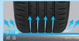
排出する水の量=タイヤの接地幅×走行距離×水深
