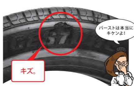
キズがタイヤ内部のコードに達している場合、タイヤが破裂し事故につながる恐れがあります。
