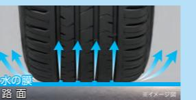
排出する水の量=タイヤの接地面×走行距離×水深
